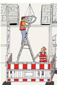
Zu den Mehrzweckleitern zählen auch Leitern, deren Schenkel durch selbsttätig sperrende Gelenke miteinander verbunden sind und die sich als Anlegeleitern, Stehleitern oder als Arbeitsbühnen aufstellen lassen. Diese Leiterbauart wird auch als Ein- oder Mehrgelenkleiter bezeichnet.
