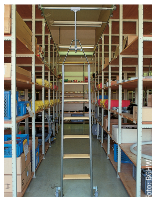
Rollleiter für Regalgänge; quer zur Laufrichtung verschiebbar
