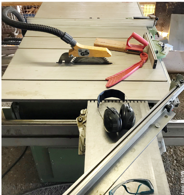
Ein Spaltkeil sichert das Werkstück gegen Rückschlag; die Spanschutzhaube dient auch als Schutz gegen das Berühren des Sägeblatts
