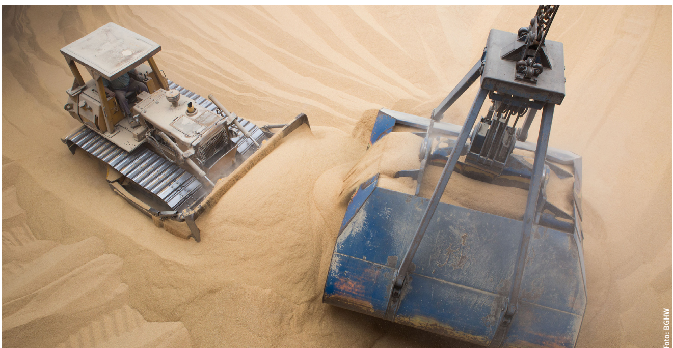
Ein Raupenfahrzeug führt im Laderaum dem Greifer das Schüttgut zu.
