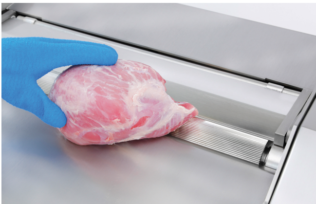
Entschwartungsmaschine zum offenen Entschwarten von rundstückigen Teilen
