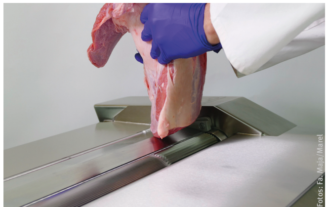
Entschwartungsmaschine zum offenen Entschwarten von rundstückigen Teilen
