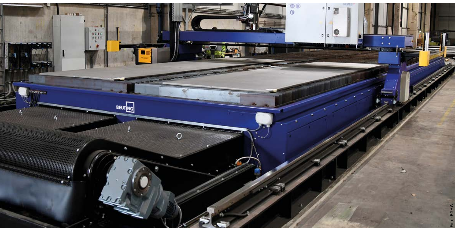
Edelstahlbleche auf dem Brenntisch einer Plasmabrennschneidanlage
