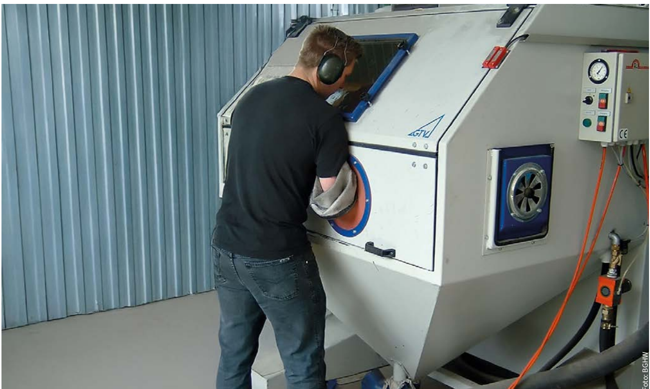
Arbeiten an einer Handstrahlkabine
