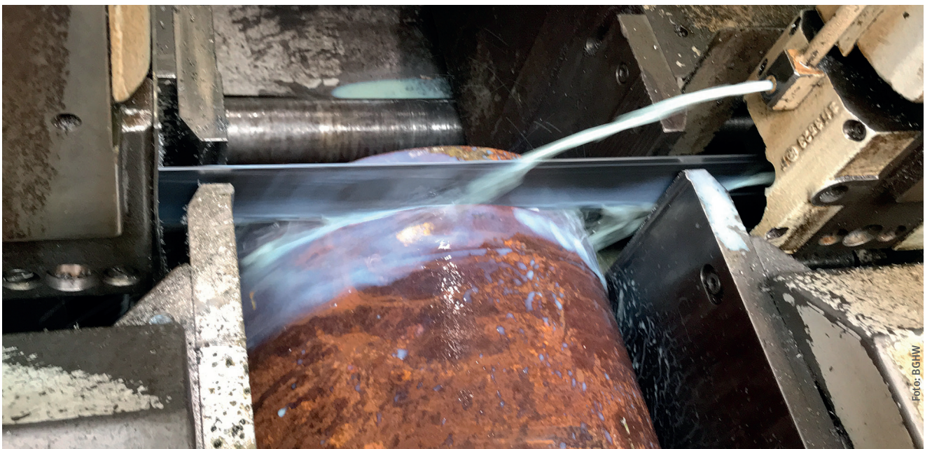
Kühlschmierstoffeinsatz an einer Bandsäge
