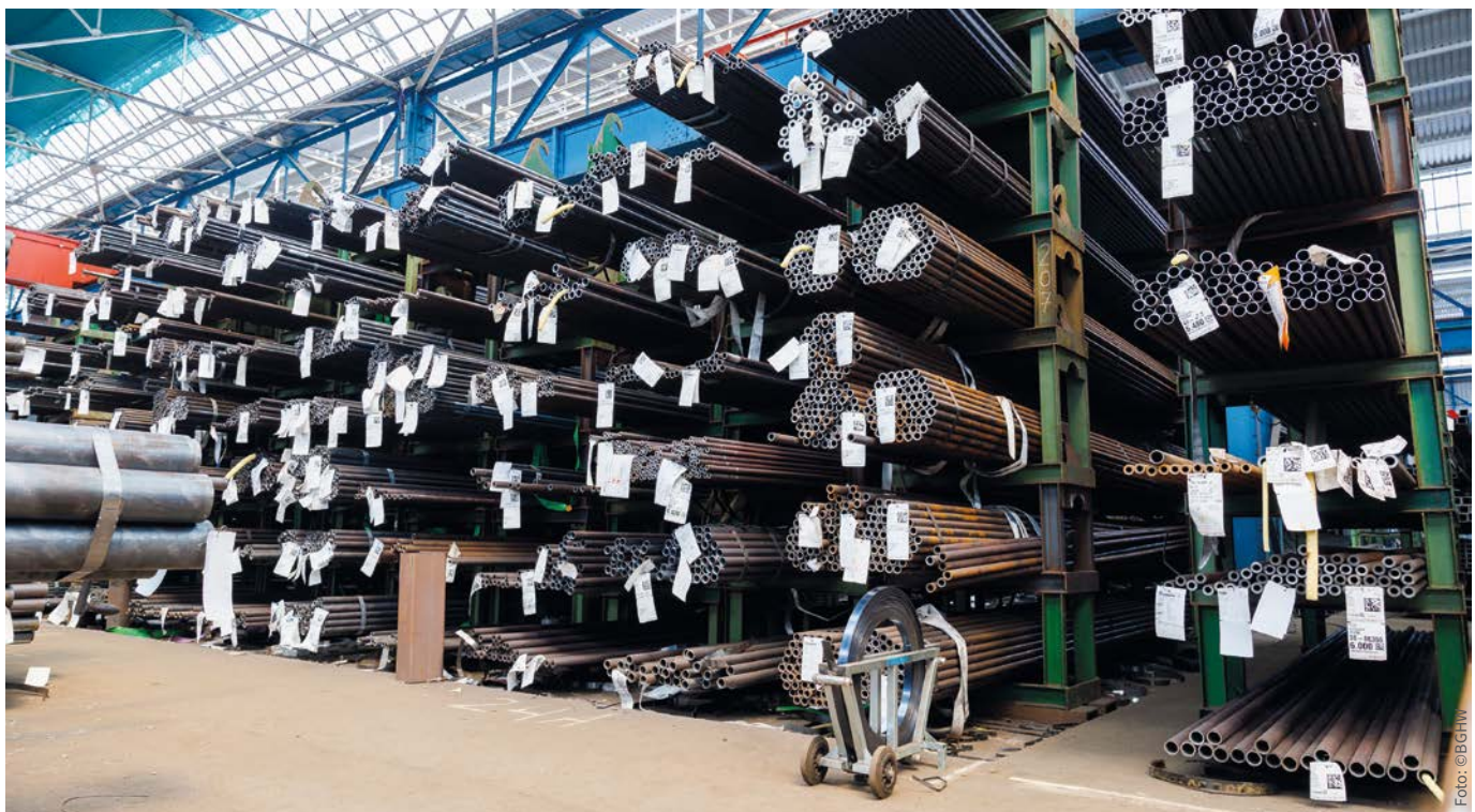
In Stapeljochen eingelagerte Stahlrohre
