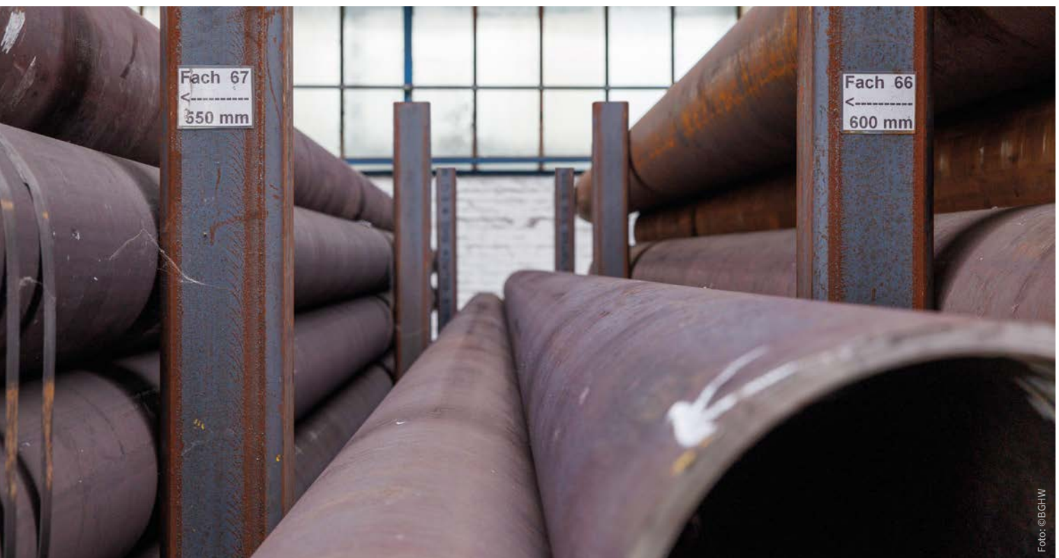
Rungenlager mit Stahlrohren
