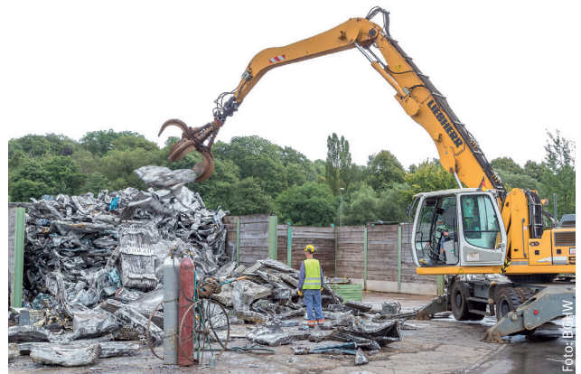
Sowohl der Mitarbeiter als auch die beiden Gasflaschen befinden sich im Gefahrenbereich des schwenkenden Baggers
