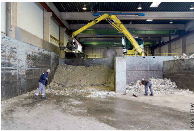
Gut gestaltetes Lager mit Trennwänden und ebenem Boden
