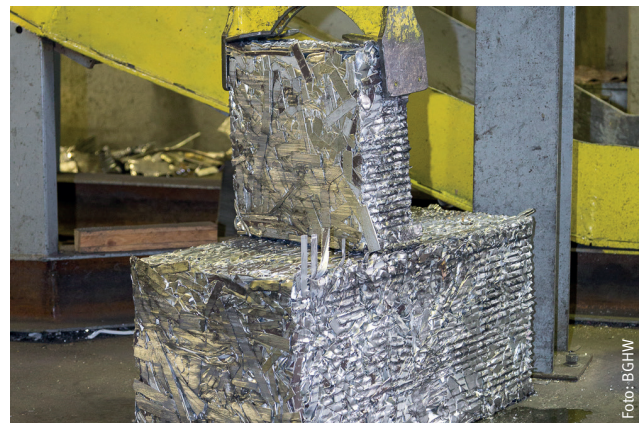
Pakete sind bei ungünstigen Platzverhältnissen mit einer Klemmzange gut handhabbar.
