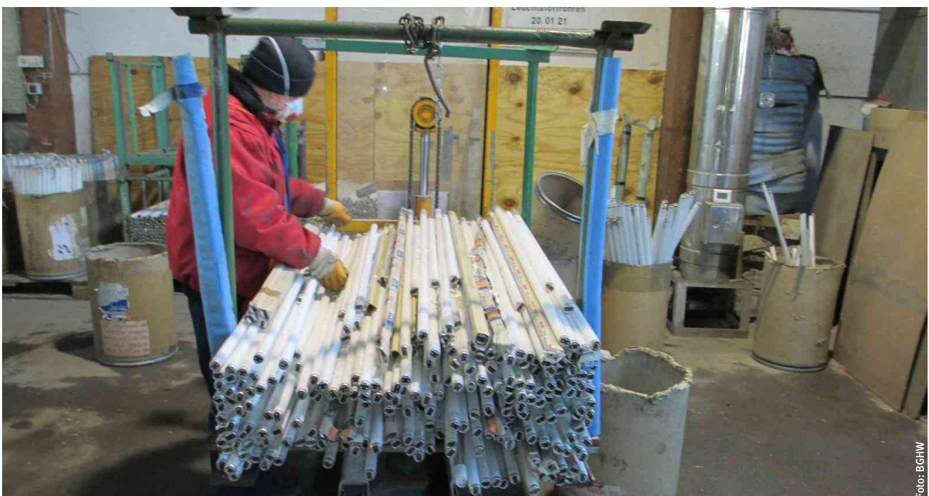
Einsatz von Atemschutz beim Umgang mit Leuchtstoffröhren
