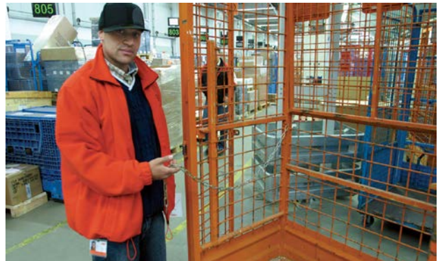
Eine Kette als Ladungssicherung in der Transportbox, beispielsweise für Fässer oder schmales Transportgut, wenn das formschlüssige Beladen nicht möglich ist
