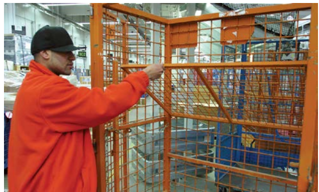
Klappboden einer Transportbox für das variable Beladen mit Paketen unterschiedlicher Größe und Form
