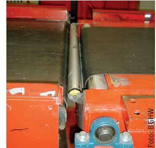
Sicherung der Einzugsstelle durch eine Springrolle
