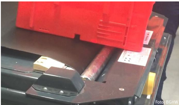
Teleskopförderer mit stirnseitiger Abschaltleiste und Füllstück zur Sicherung der Auflaufstelle, die beim Einteleskopieren durch das Abheben des Bandes zugänglich wird.
