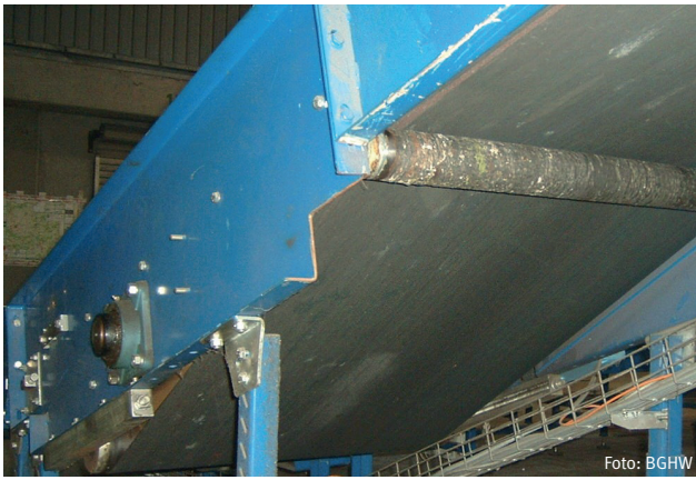
Ungesicherte Auflaufstellen an der Untergurtrolle und der Trommel
