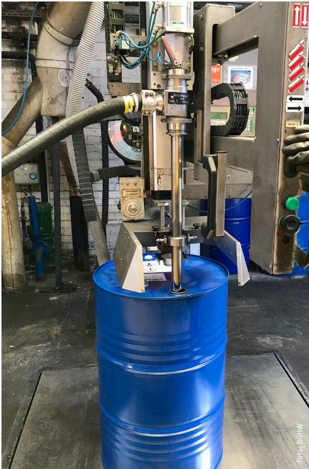
Fassabfüllung mit Fülllanze und hufeisenförmiger Randabsaugung
