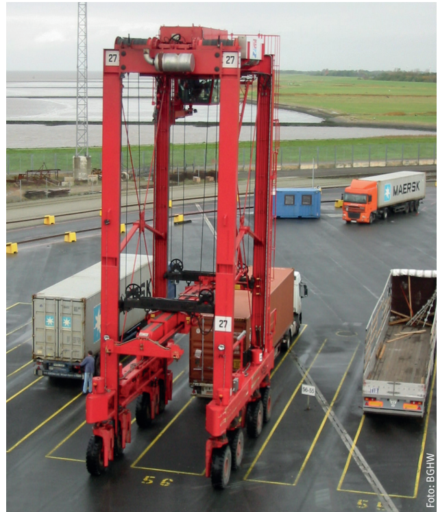
Portalstapler beim innerbetrieblichen Containertransport
