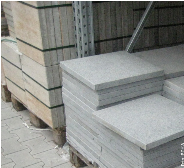
Plattenlagerung liegend (richtig) und stehend (falsch)
