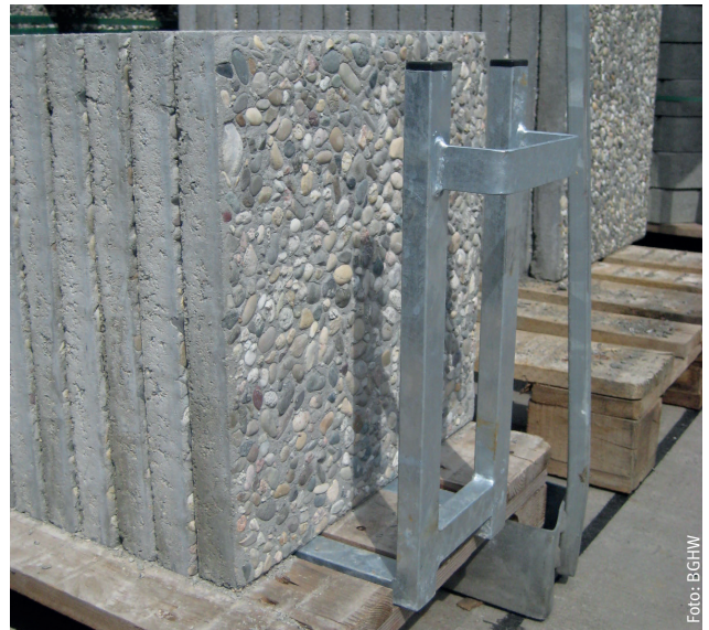
Plattenlagerung mit Stützen
