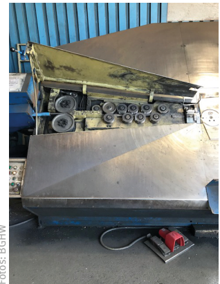
Geöffnete Abdeckung an Rollenrichtsatz
