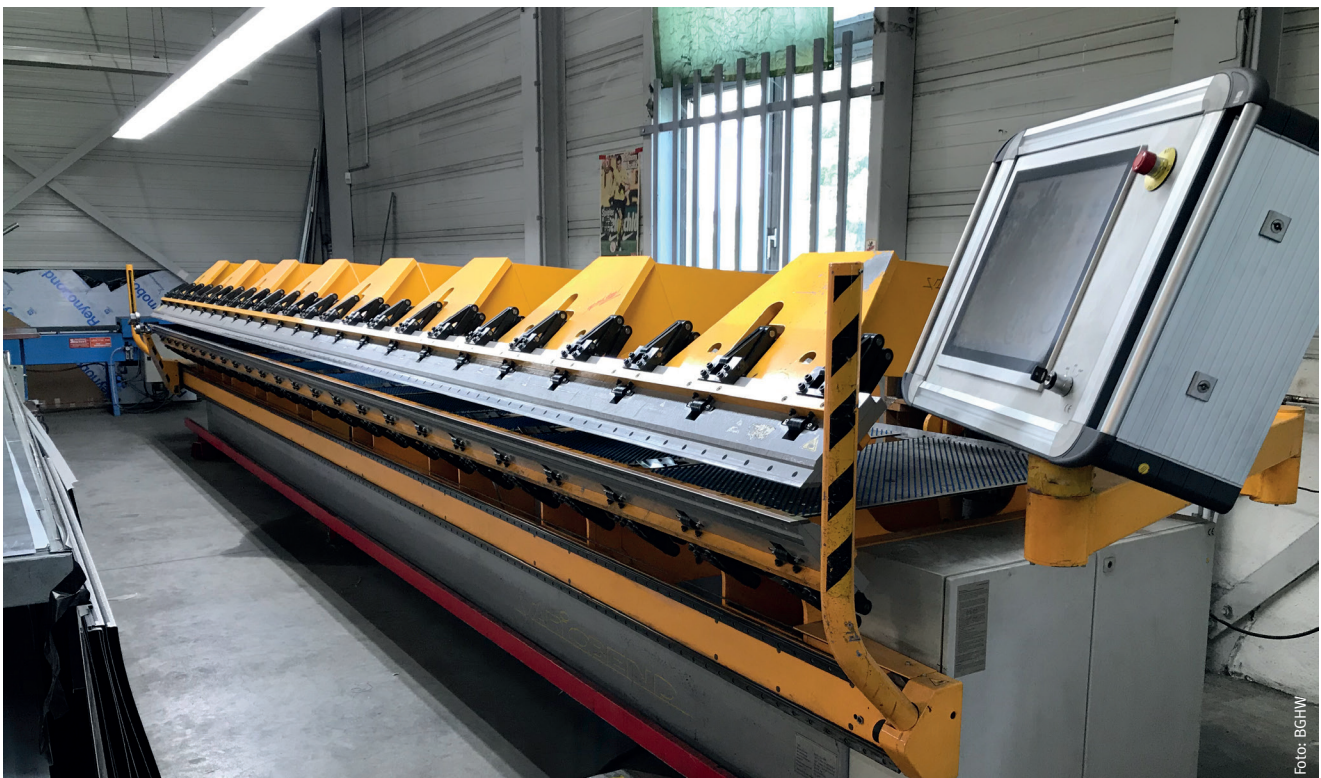
Doppelschwenkbiegemaschine mit Schneideinrichtung
