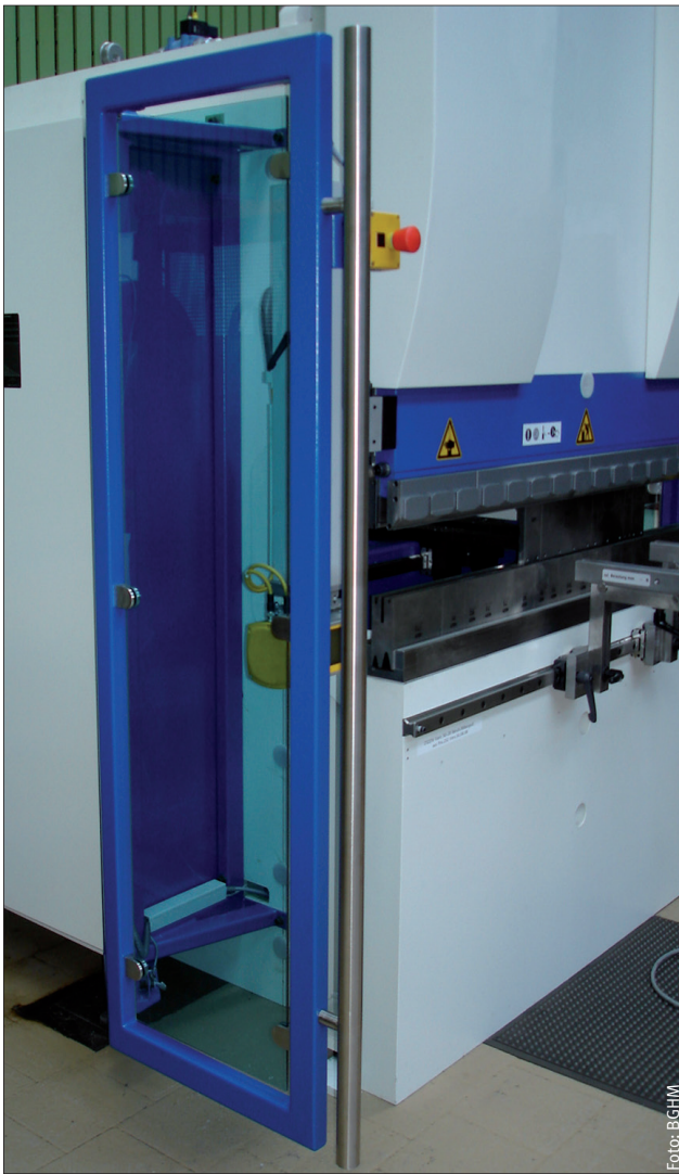
Seitliche Verdeckungen an einer Gesenkbiegepresse
