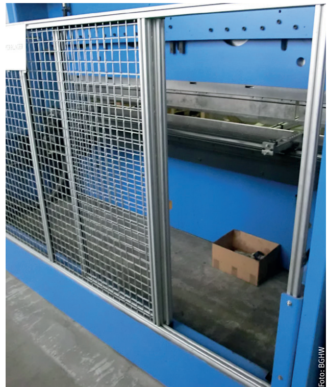
Mit Positionsschalter gesicherte Schiebetür an der Pressenrückseite
