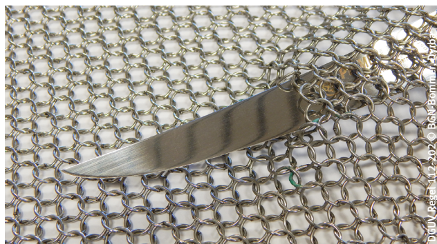
Durchstichtiefe des Messers bei nur einem fehlenden Ring
