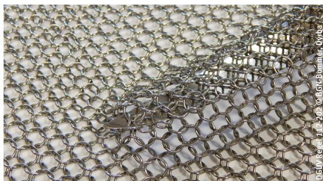
Durchstichtiefe des Messers bei intaktem Gewebe
