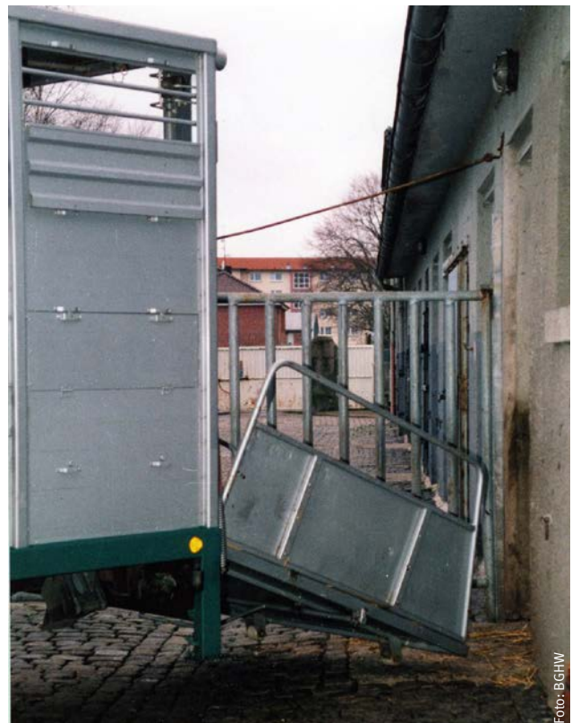
Fahrzeugeigene Rampe am Viehtransporter
