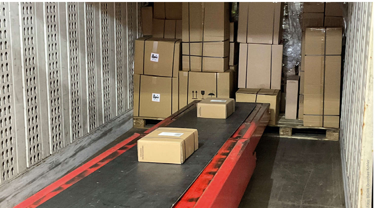
Wechselbrücke mit Teleskop-Transportband
