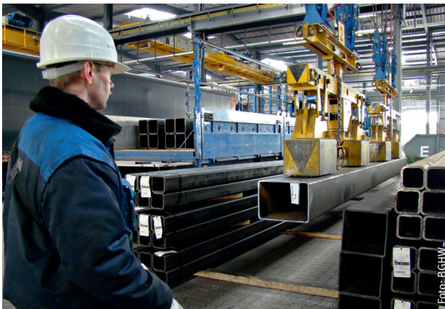
Innerbetrieblicher Krantransport mit Lasthebemagnet
