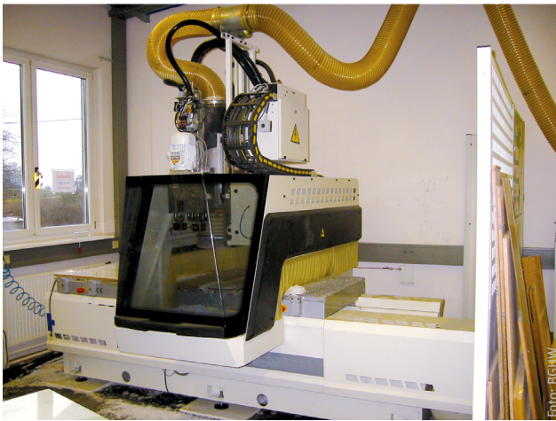
Kapselung an einer Fräsmaschine
