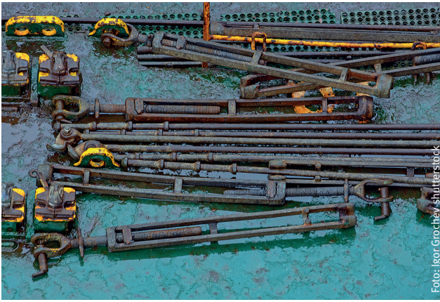
Lärmquellen beim Containerumschlag: Laschstangen und Twistlocks
