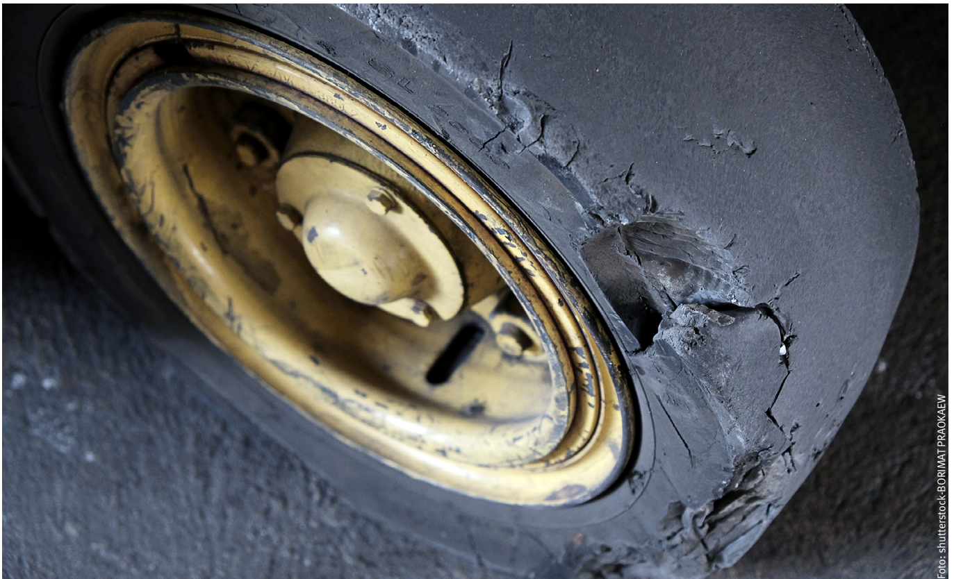
Mit solchen Reifen ist ein Gabelstapler nicht mehr sicher
