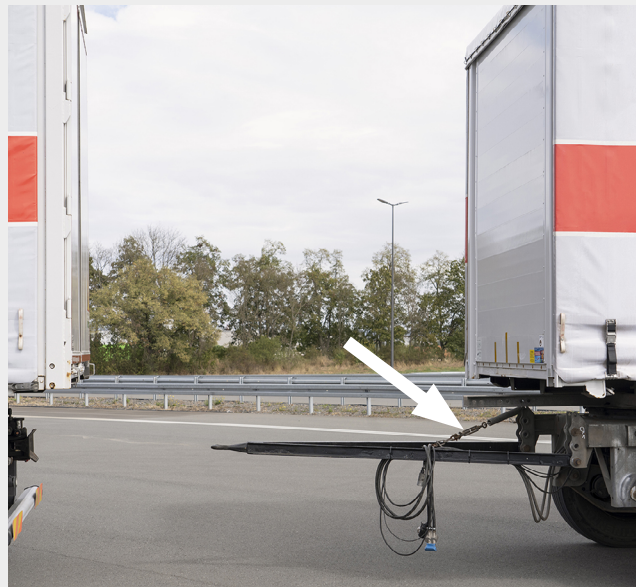
Zugöse mit der Höheneinstelleinrichtung (Pfeil) auf Kupplungshöhe einstellen
