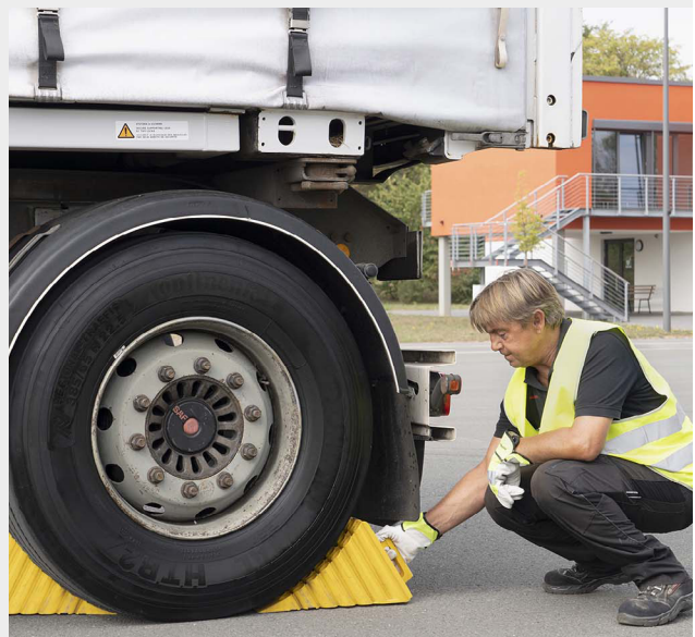
Unterlegkeile formschlüssig anlegen – an den Rädern der hinteren Achse des Anhängers
