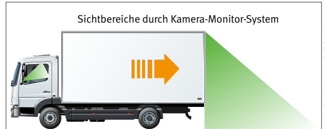
Ein Kamera-Monitor-System (KMS) zeigt dem Fahrer den Bereich hinter dem Fahrzeug auf einem Monitor im Armaturenbereich an.
