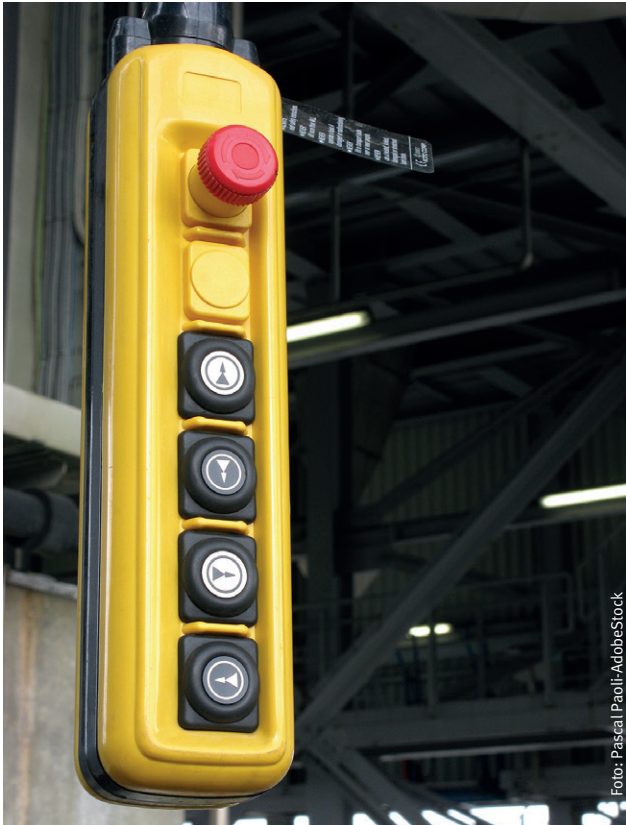
Steuereinrichtung mit Not-Halt-Schalter
