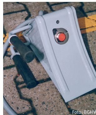
Vorlegekeil mit einem Sensor zur Reifenerkennung
