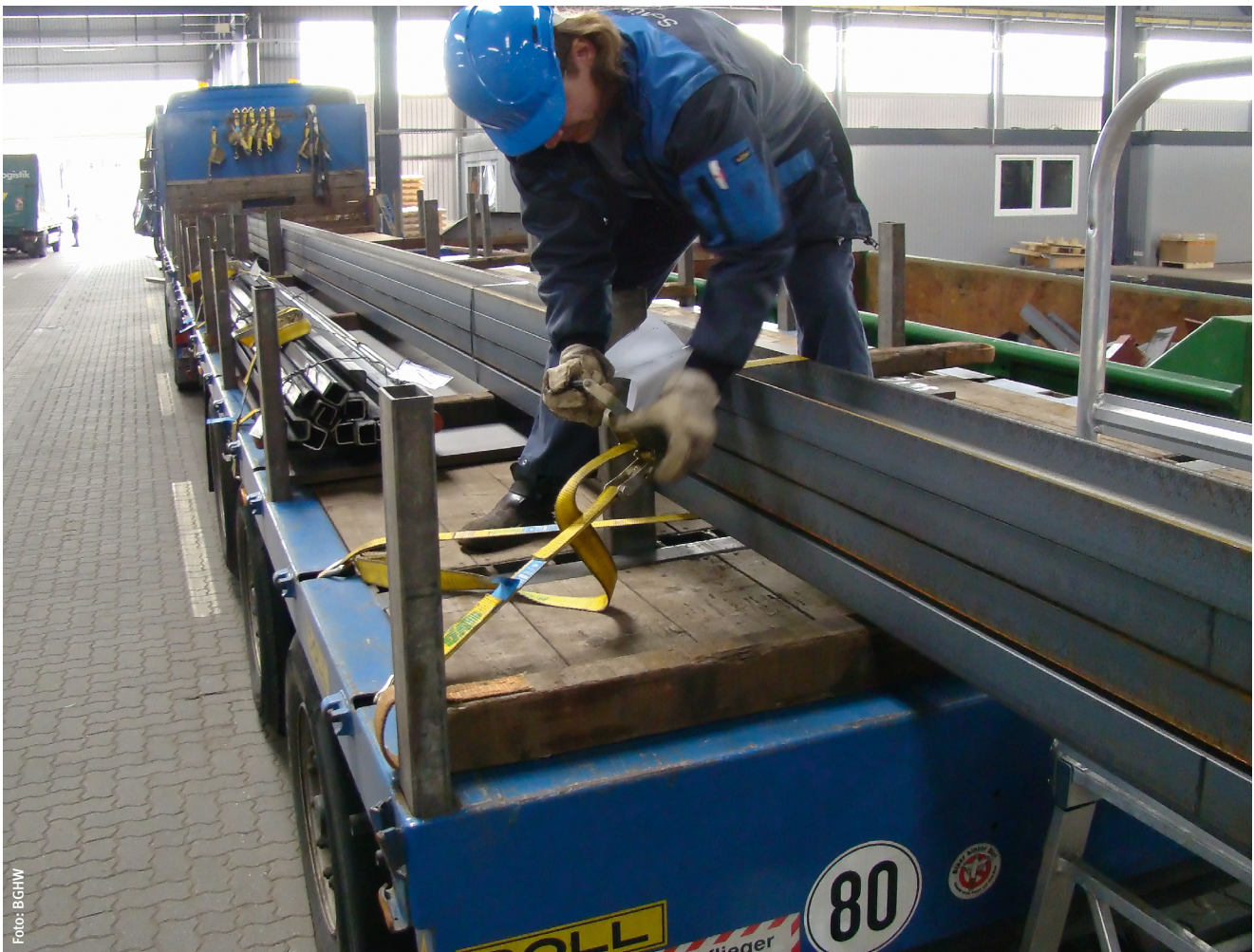
Ladungssicherung auf einem Lkw mit Steckungen und Zurrgurten
