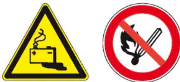
Abbildung 4: Erforderliche Warn- und Verbotsschilder für eine Batterieladeanlage
