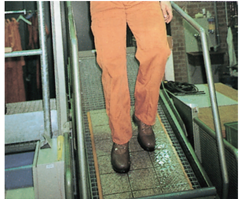
Bild 1: Bestimmung der Rutschhemmung von Bodenbelägen mit dem Begehungsverfahren
