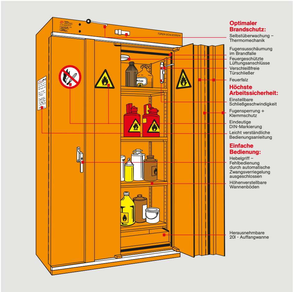
Bild 5 Selbstschließender und -verriegelnder Sicherheitsschrank zur Aufbewahrung brennbarer Flüssigkeiten, der auch für andere gefährliche Stoffe und Zubereitungen geeignet ist.
