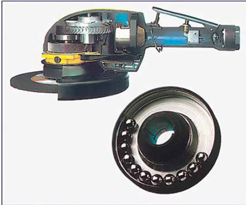
Unwuchtausgleich (Kugeln) bei einer Schleifmaschine
