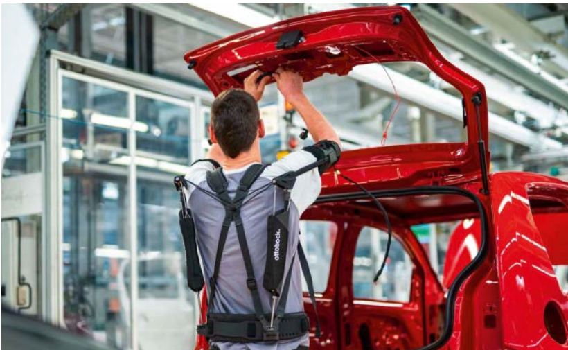
Abb. 1: Passives Exoskelett Paexo der Fa. Otto Bock,
