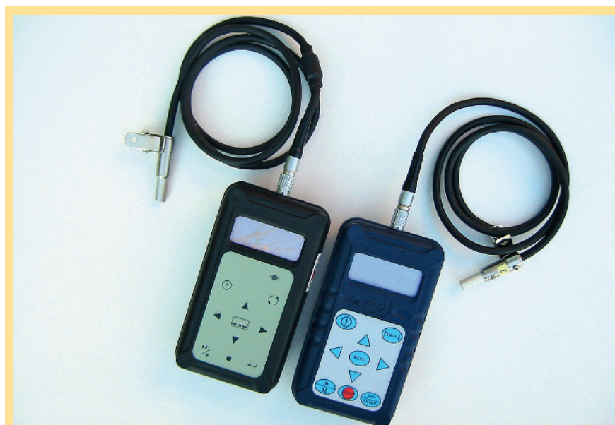
Abbildung 2: Verwendete Schalldosimeter für die betrieblichen Messungen bei den Monteuren in der PKW-Reifenmontage.
