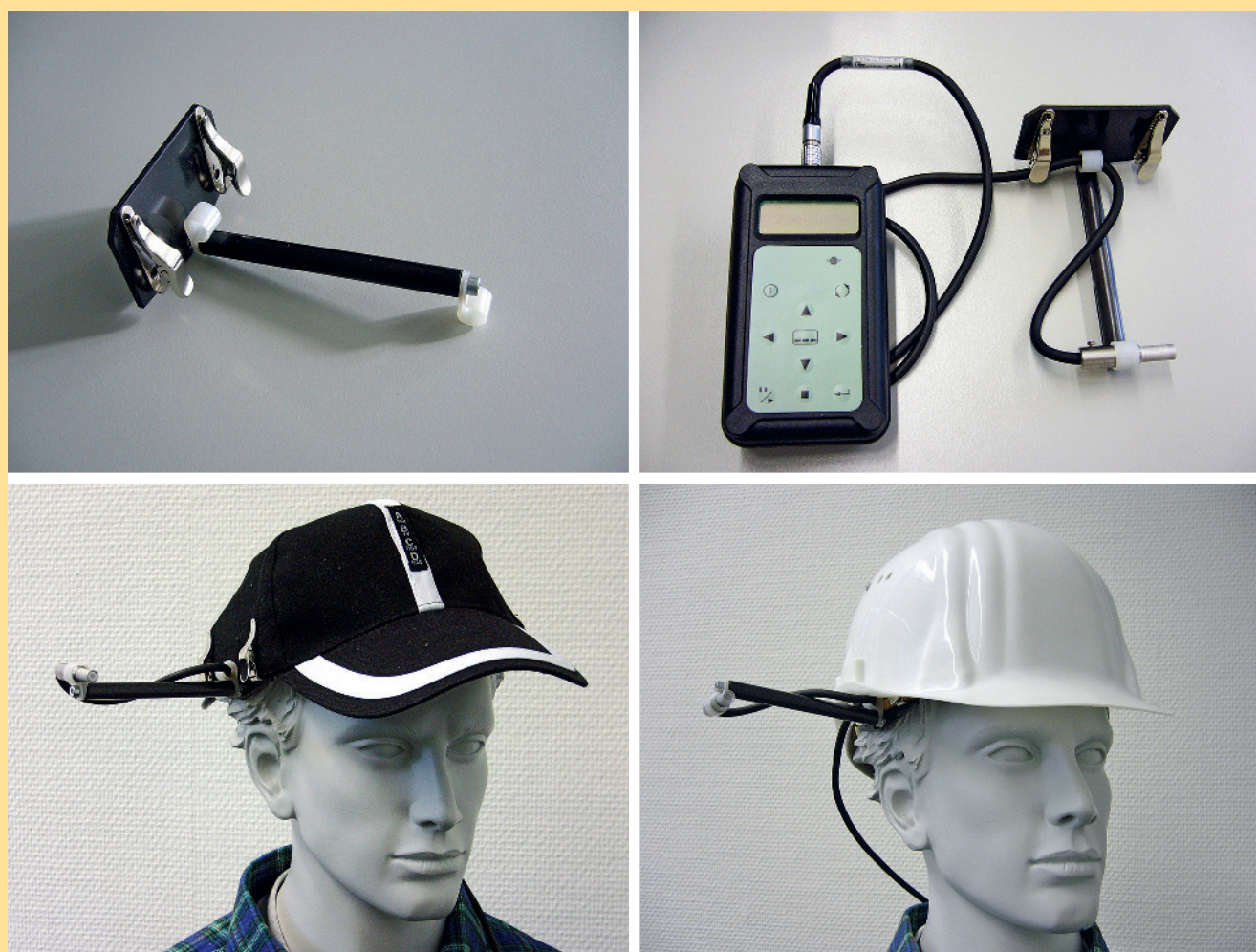
Abbildung 3: Messanordnung der Dosimetermikrofone für betriebliche Schalldosimetermessungen.
