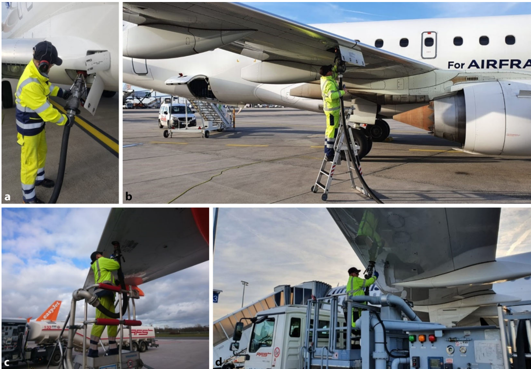
Abb. 1 ◀ Anschließen des Tankschlauches am Flugzeug vom Boden (a), von einer Stufenstehtleiter (b), von einer Nachlaufleiter (c) und von der Hebebühne auf einem Dispenserverfahrzeug (d)
