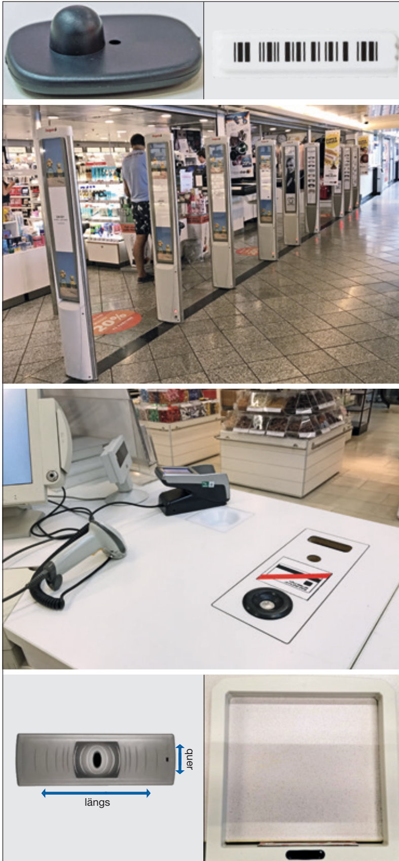
Abb. 1: Auswahl von Komponenten elektronischer Artikelsicherungssysteme: (von oben nach unten) 2 unterschiedliche Sicherungsmittel, Sicherungsschleusen, Deaktivator und Magnetlöser verbaut im Kassentisch, Deaktivator-Pad und -Loopantenne
