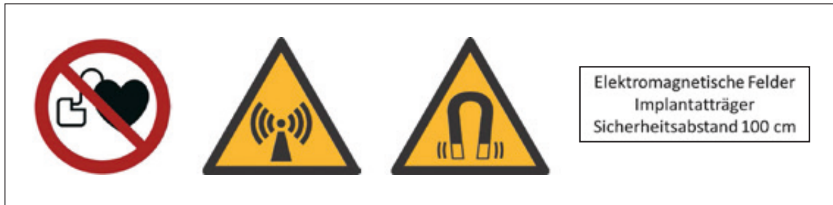
Abb. 5: Sicherheits- und Gesundheitsschutzkennzeichnung nach ASR A1.3 inkl. Zusatzzeichen für Magnetlöser und Deaktivator (links und Mitte), für Sendeantenne (rechts);
