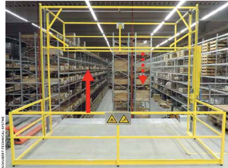
3 Öffnen und Schließen durch gegenläufiges Heben/Senken
