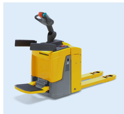
Abb. 1 ▲ Deichselhubwagen mit klappbarer Plattform (Mit freundl. Genehmigung der Jungheinrich AG)
