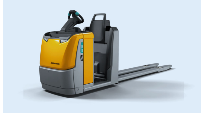
Abb. 3 ▲ Kommissionierfahrzeug (Mit frendl. Genehmigung der Jungheinrich AG)
