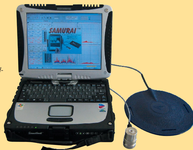
Abbildung 3: Messsystem Soundbook mit Beschleunigungsaufnehmern für den Sitz (blaue Scheibe) und den Sitzmontagepunkt (Zylinder).
