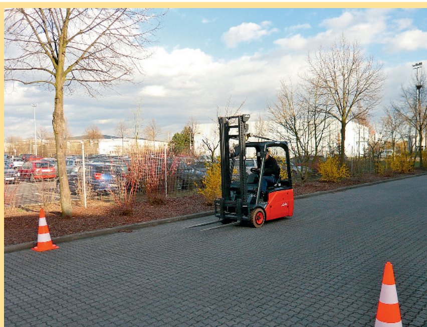
Abbildung 2: Die Teststrecke der Messreihen 2 und 3. Die Fahrstrecke ist etwa 50 Meter lang. Die Start- und Ziellinie sind durch rot-weiße Pylone gekennzeichnet.
