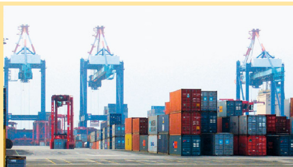
Abbildung 3: Be- und Entladung von Containerschiffen durch Portalkrane und Portalstapler. Im Hintergrund sind Portalkrane bei der Be- und Entladung eines Containerschiffes zu sehen. Den Weitertransport auf dem Betriebsgelände übernehmen die Portalstapler.
