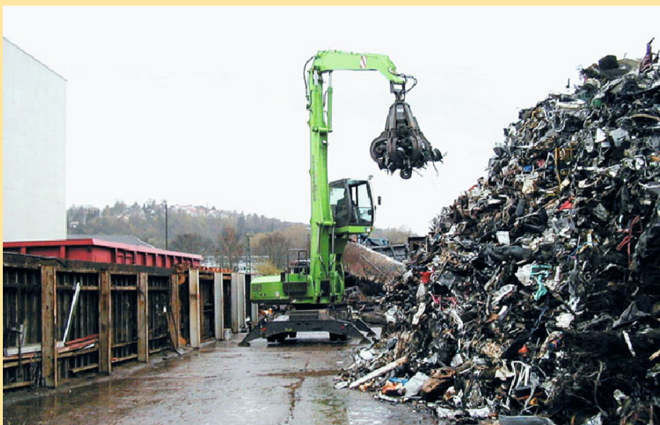
Abbildung 6: Mobilbagger im Schrottgroßhandel bei der Beladung eines Eisenbahnwaggon. Die Fahrerkabine beim Mobilbagger ist angehoben, damit der Fahrer eine bessere Sicht in den zu beladenden Eisenbahnwaggon hat.
